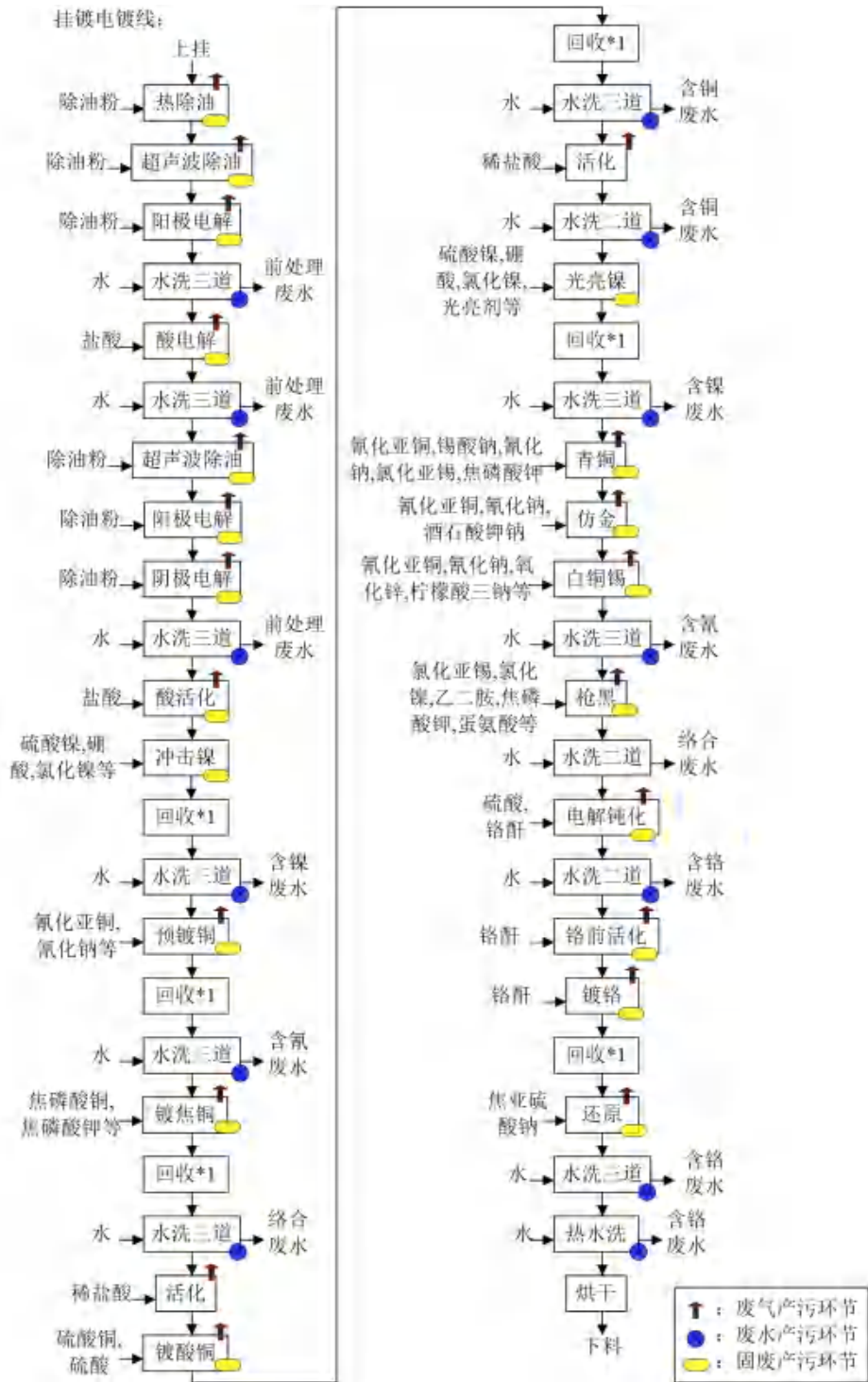
图 2.1-7 揭阳市鑫晟利金属表面处理有限公司生产工艺及产污环节
