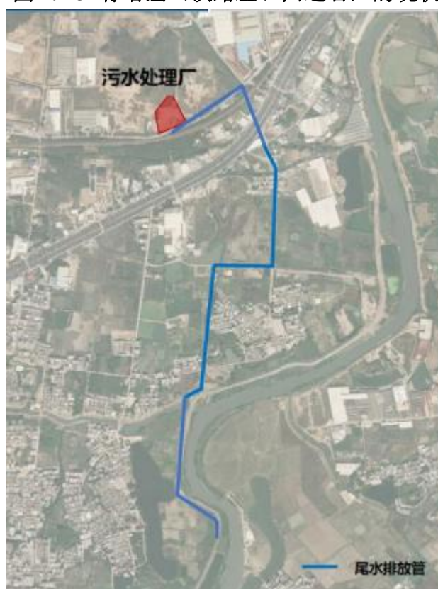
图 4.2-4 尾水排放管管网路线示意图
